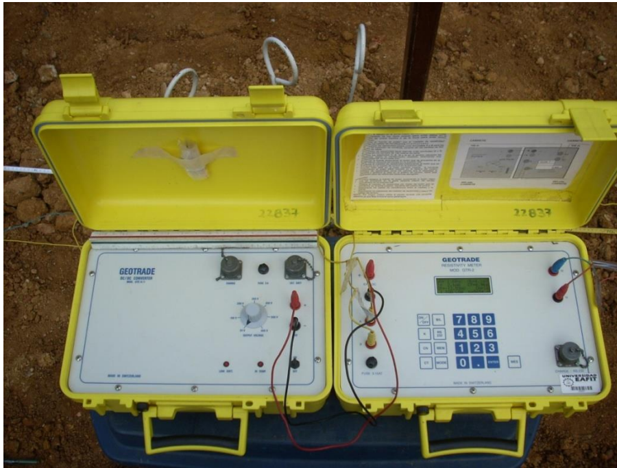
Figura 5.2. Equipo geoelectrico Geotrade –Universidad EAFIT.
