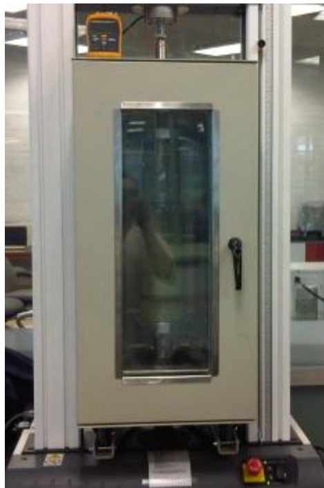
Imagen 14. Cámara de temperatura instalada en la INSTRON
