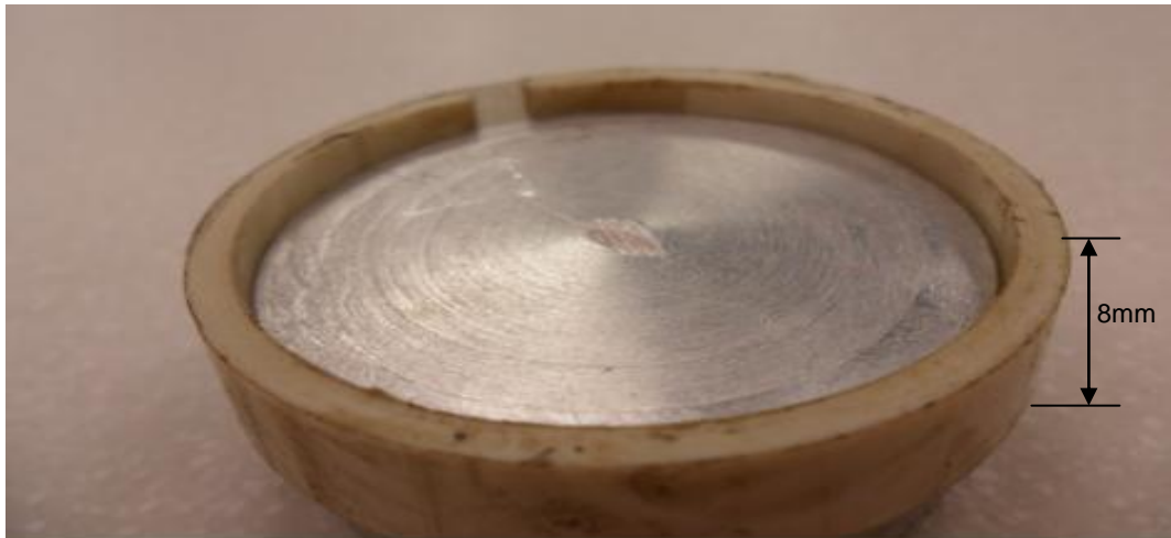
Imagen 5. Recipiente fabricado con moneda de aluminio y aro de PVC
