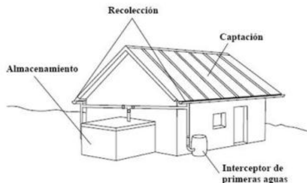
Figura 30. Esquema básico para la recolección de aguas lluvias:
