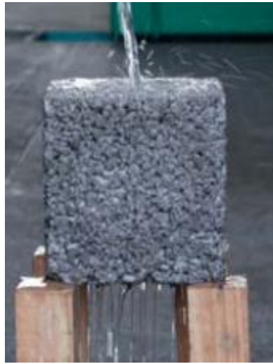
Figura 21. Pavimento permeable en hormigón.
