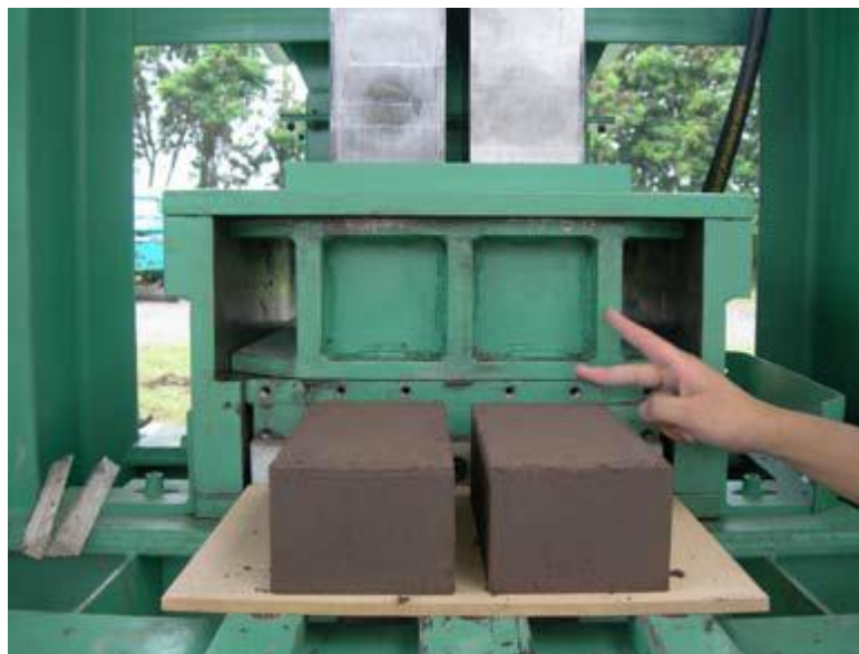
Figura 9. Ladrillos que contienen ceniza de carbón, escoria siderúrgica, escoria de cobre.
