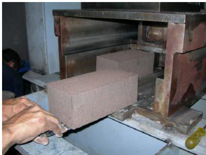
Figura 10. Ladrillos con base en escoria de cobre, ceniza de carbón, residuos de porcelana eléctrica.
