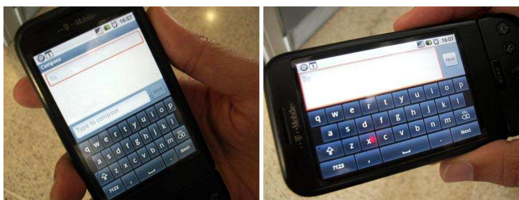
Foto 3. Propuesta de control remoto multitáctil (basado en tacto) desde un teléfono celular. Incluye teclado virtual con rotación de pantalla. Prototipo en desarrollo por el proyecto Ártica.
