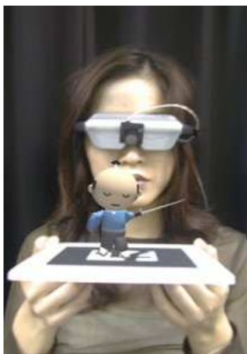
Figura 2: Uso típico de la RA. La usuaria visualiza un modelo cuya posición está ligada al marcador sostenido por ella.
