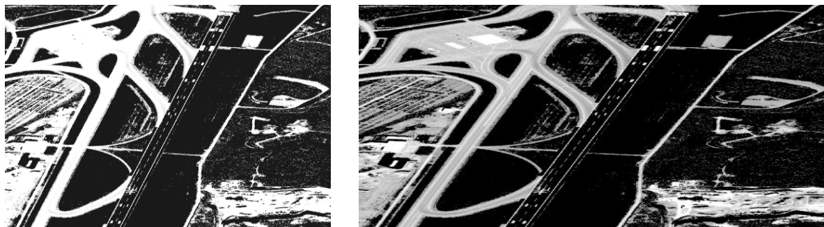
Рис. 2. a) – обробка Гаусівським фільтром, б) – обробка модифікованим Гаусівським фільтром
