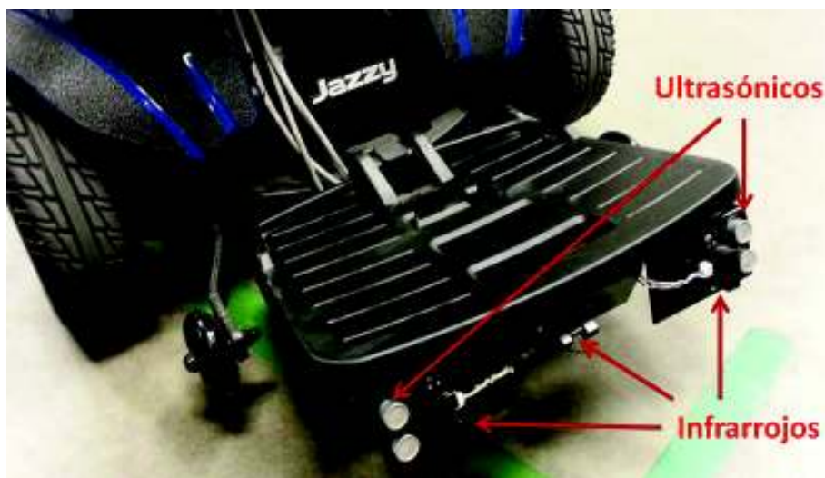
Ilustración 45. Sensórica instalada en la silla para la detección de riesgos para el usuario (foto tomada por Luis David Jiménez, 10 de mayo de 2013, Espacio para la Integración Tecnológica, Universidad EAFIT)
