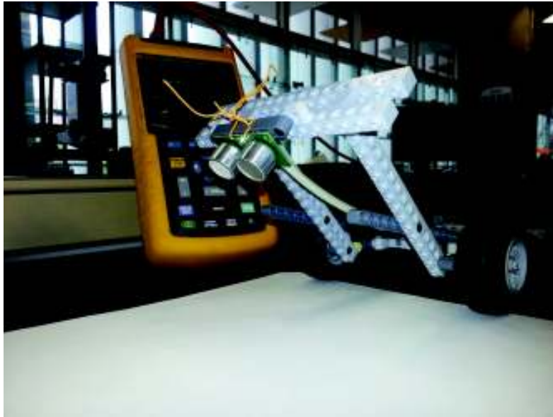
Ilustración 44. Sistema en Lego® para determinar el ángulo de instalación de los sensores para detectar vacíos (foto tomada por Luis David Jiménez, 13 de marzo de 2013, Espacio para la Integración Tecnológica, Universidad EAFIT)
