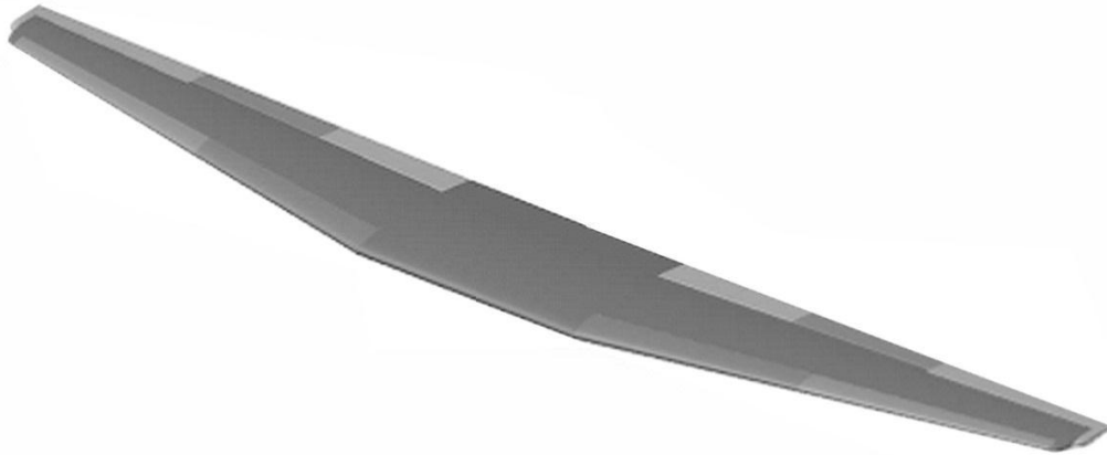
Рис. 2. Модель майстер-геометрії крила літака
