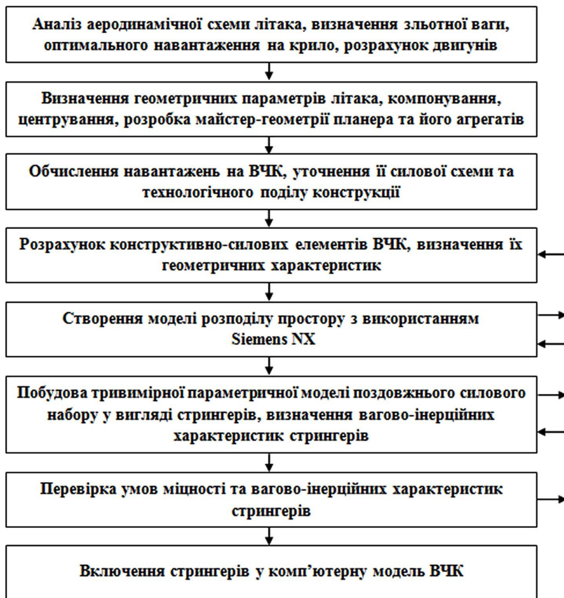
Рис. 1. Блок-схема проектування стрингерів ВЧК літака
