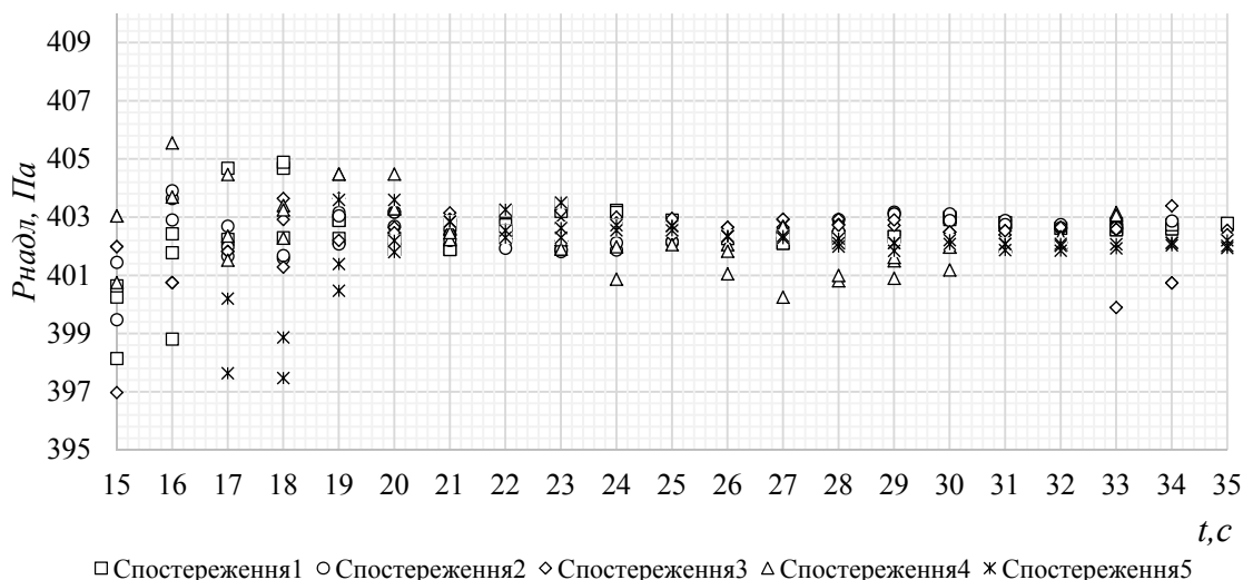
Рис. 4. Розподіл значень тиску для п'яти незалежних спостережень за об'ємної витрати Q=40 м 3 /год
