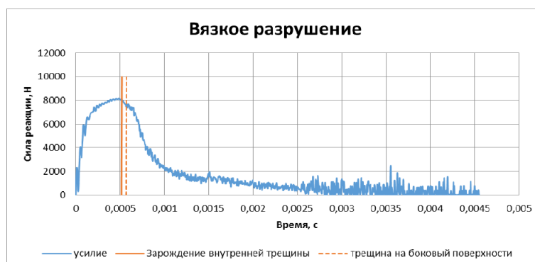
Рис. 4. Моменты зарождения трещины в образцах с боковыми надрезами на диаграммах усилие-время для случаев: а) – хрупкого разрушения, б) – квази-хрупкого разрушения, в) вязкого разрушения
