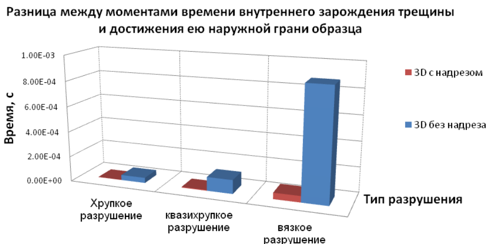
Рис. 5. Разница по времени между моментами зарождения трещины внутри образца и на боковой поверхности для стандартных образцов Шарпи и образцов с боковыми надрезами
