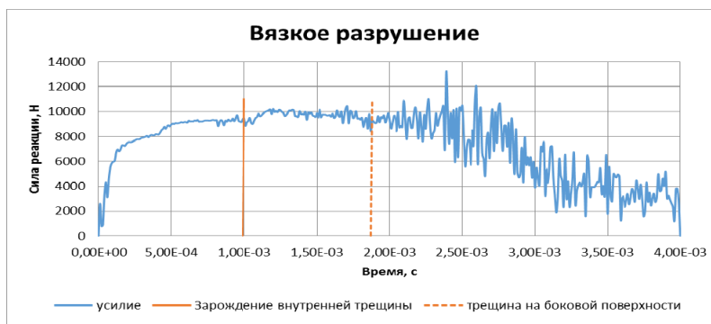
Рис. 3. Моменти зародження тріщини в стандартних образцах Шарпи на диаграммах усилие-время для случаев: а) – хрупкого разрушения, б) – квази-хрупкого разрушения, в) вязкого разрушения
