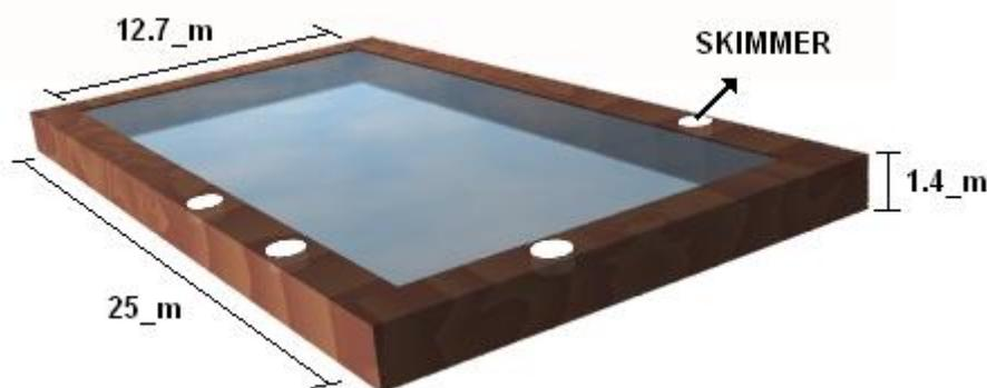
SKIMMER: Dispositivo utilizado para retener partículas de gran tamaño, en la succión del agua para la recirculación.
