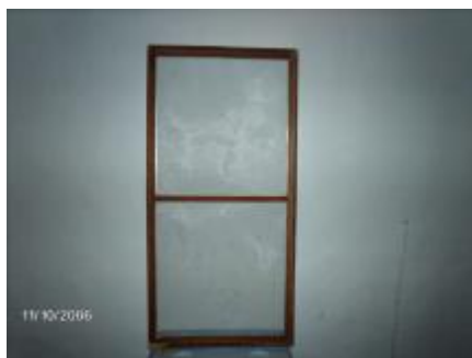
FIGURA 4.4 Zaranda utilizada para la separación del aserrín.
