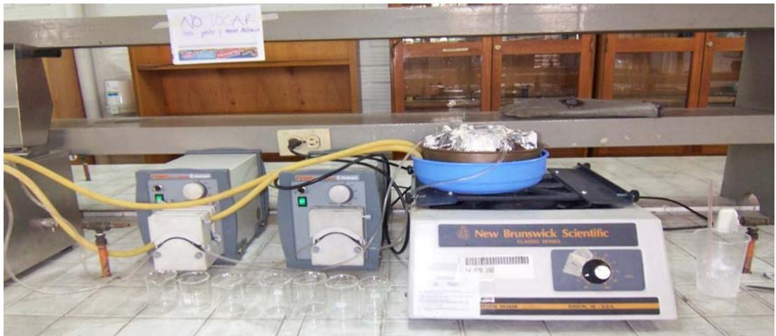
Figura 11. Extractor propuesto a escala laboratorio
