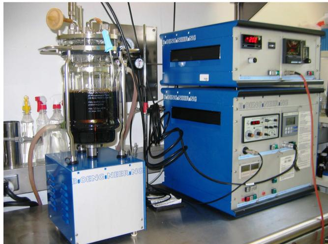
**3.4.2.1 Condiciones del cultivo.** Los procesos de fermentación se realizaron a una velocidad de agitación de 200 rpm, empleando dos agitadores tipo Rushton de 6 paletas planas, a un pH inicial de 6.0, a una velocidad de aireación de 1 vvm y variando para cada experimento la temperatura. La densidad de inóculo empleada para el proceso correspondió al 10% del volumen del ensayo, la edad del inóculo era de 12 horas y la densidad celular de 1.592 g/L que correspondía a una absorbancia de 0.207.
