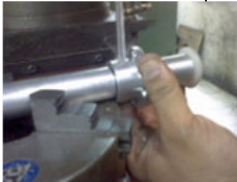
Figura 86. Perforación de soporte y tubo
