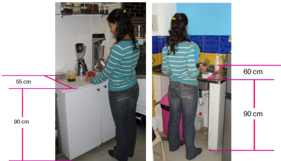
Figura 38. Medidas de mesa de trabajo de Fresa Frambuesa
