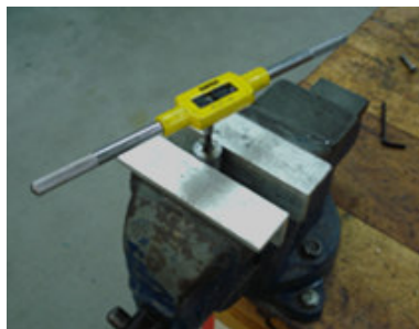
Figura 84. Roscado de cilindros con machuelo de 5/16"
