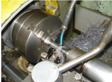
Figura 83. Maquinado de cilindros de acero en torno
