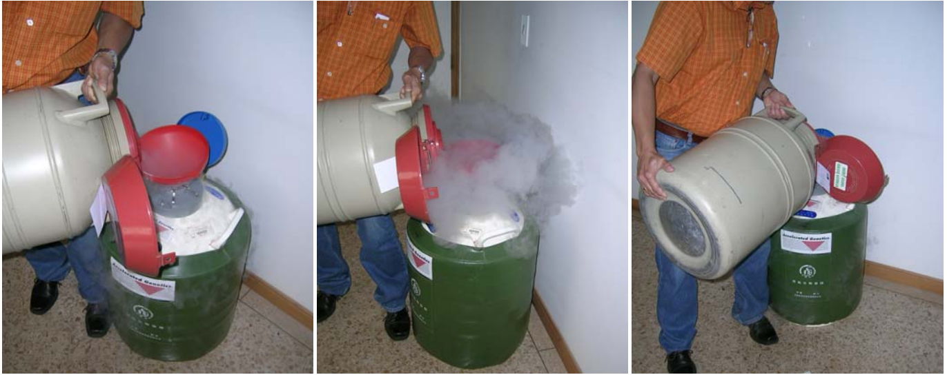
Fig. 21. Forma en que se llenan actualmente los termos de nitrógeno líquido.
