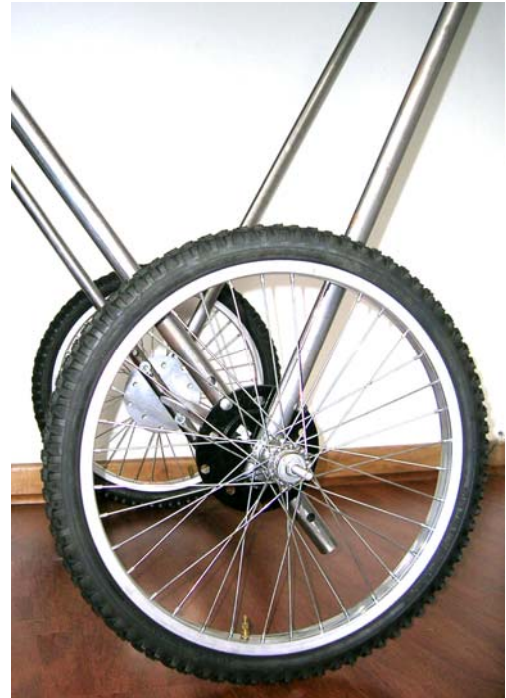
Fig. 42 Primer modelo con materiales reales. Ensamble con el disco y plegado
