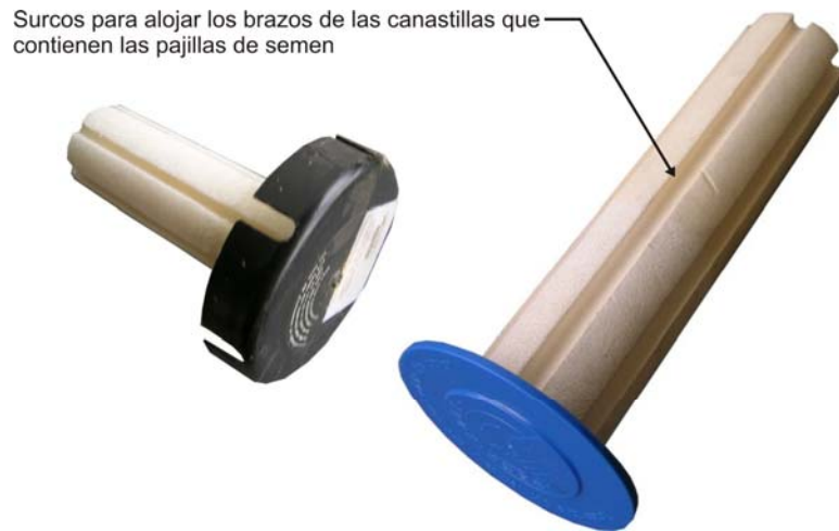
Fig. 4 Tapas de dos tamaños y referencias de termos diferentes fabricadas en tecnopor
