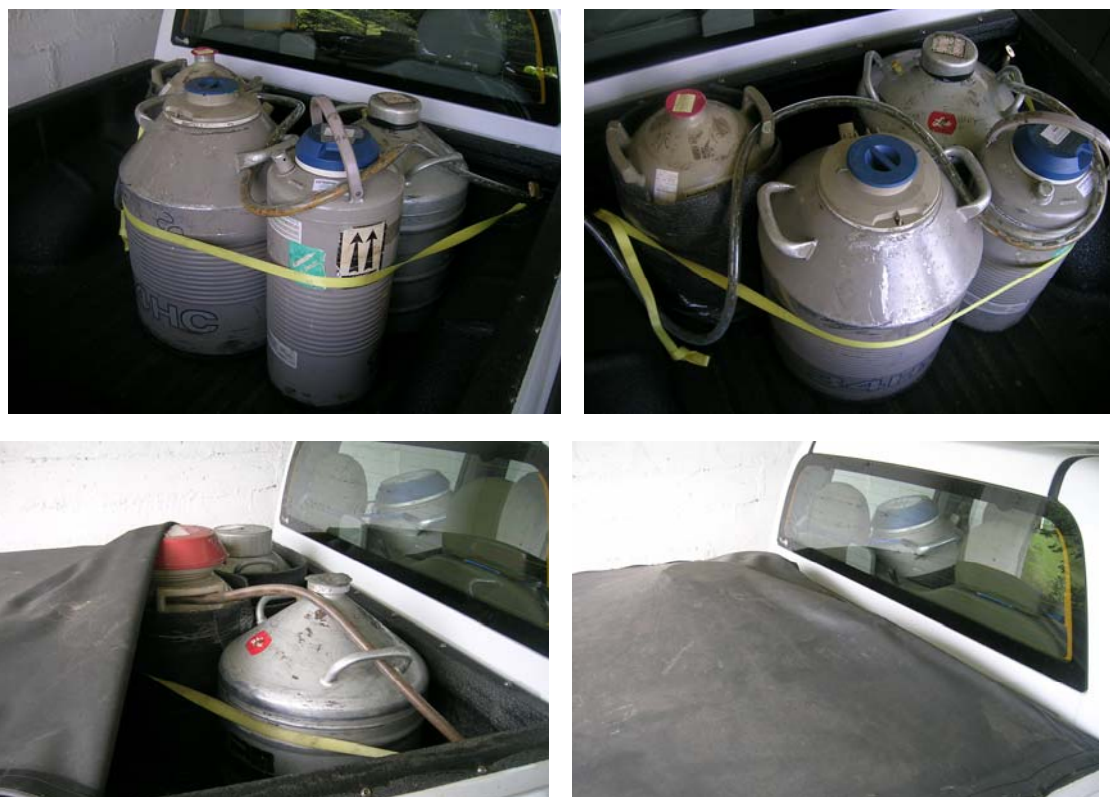
Fig. 18 Forma en que son asegurados y protegidos los termos dentro de la camioneta que emplea la empresa para su transporte.
