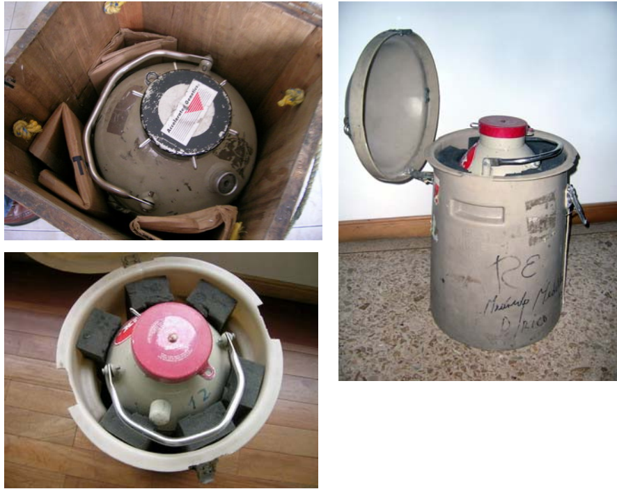
Fig. 20 Forma en que son protegidos los termos dentro de los guacales.
