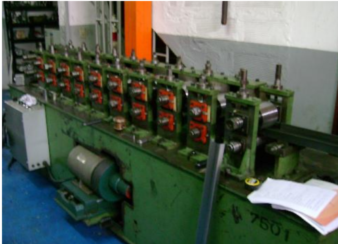
Figura 8. Once estaciones de rolado entre ellas dos guías que eliminan el movimiento horizontal (fotografía cortesía de Industrias metálicas Miller)
