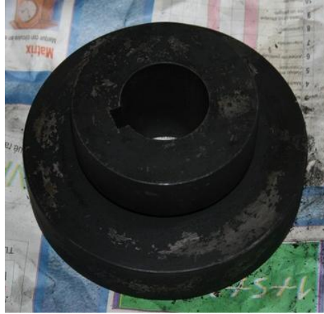
Figura 95. Detalle del rodillo M71 después de la cementación.
