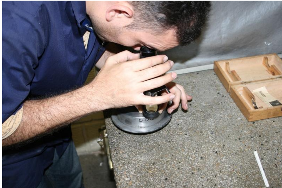
Figura 91. Detalle de la lupa utilizada para identificar las marcas microscópicas por la carga de 3 Kgf
