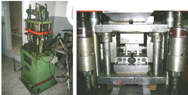
Figura 15. Punzón en vuelo marca Samco, para corte y troquelado de lámina (Fotografías cortesía de Industrias metálicas Miller)
