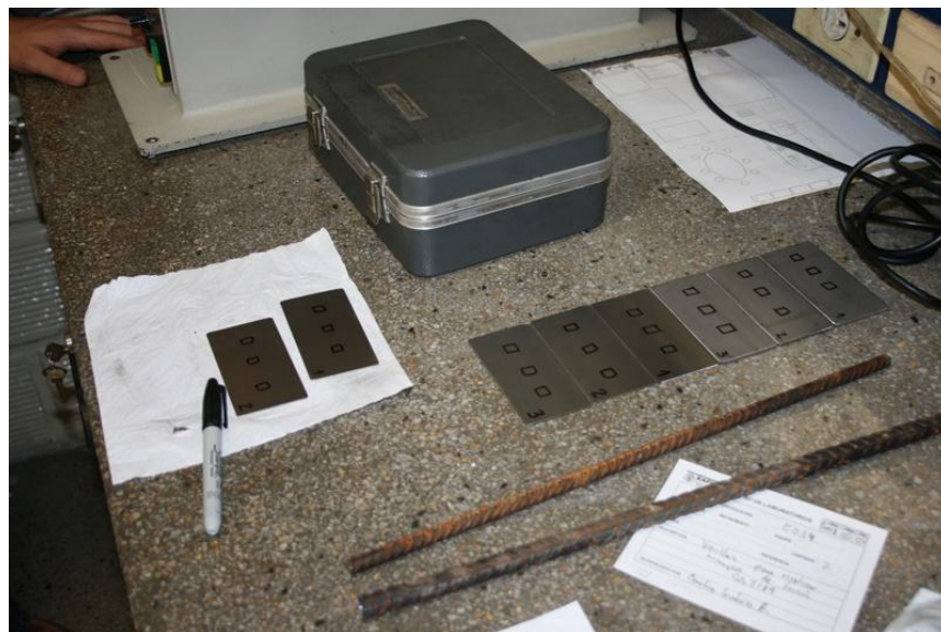
Figura 85. Marcas detalladas en cada una de las probetas analizadas Láminas de acero Cal 20, 16, 12 respectivamente,
