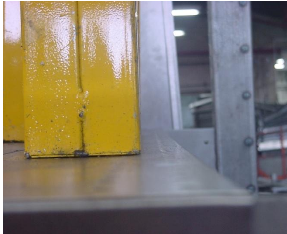
Figura 80. Curvatura generada sobre la bandeja por una carga de 120 Kg.
