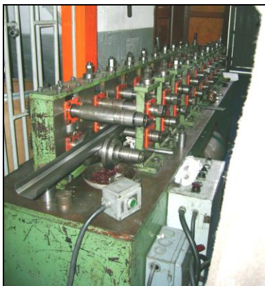
Figura 14: perfil en C siendo rolado por la maquina (Fotografía cortesía de Industrias metálicas Miller)
