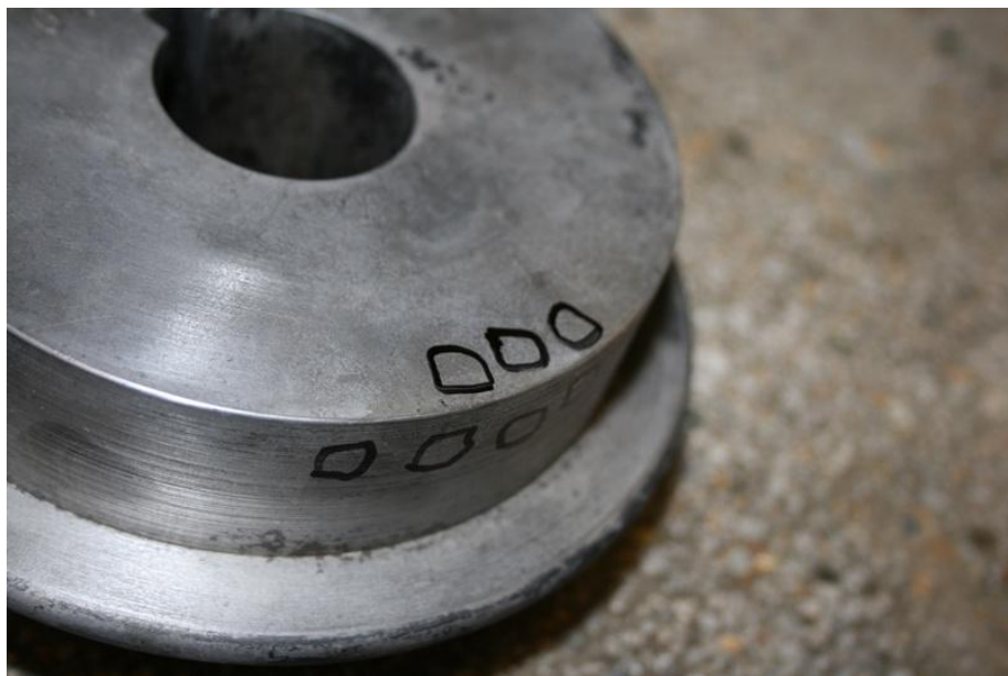
Figura 90. Marcas de indentación de diamante, están ubicadas en el centro de cada uno de los cuadros negros
