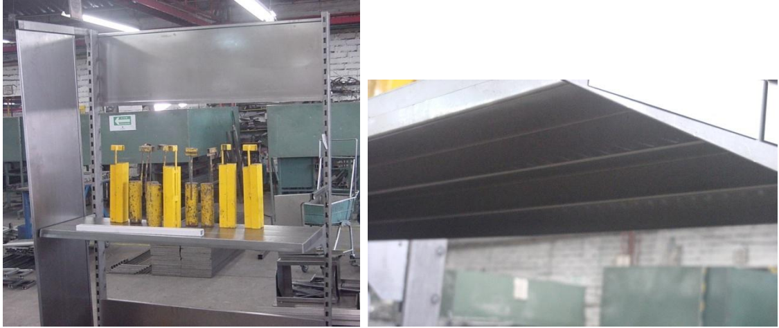
Figura 79. Montaje para la realización de pruebas. Consiste en: columna tipo CFR, objeto del estudio y los paneles de unión entre columnas
