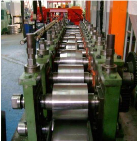
Figura 10. Restricción en dimensión máxima del fleje de lámina 170 mm (Fotografía cortesía de Industrias metálicas Miller)
