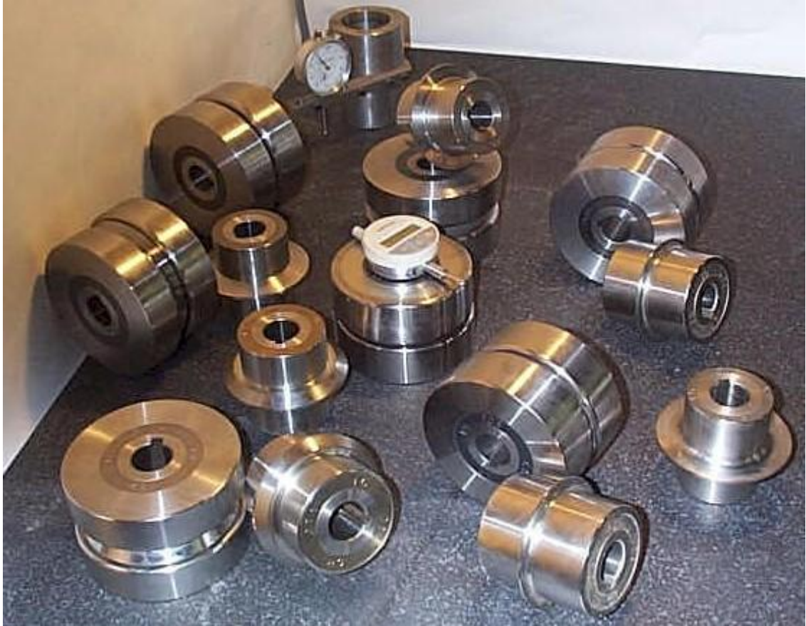
Figura 74. Herramental preliminar para rolado de entrapaño tipo D
