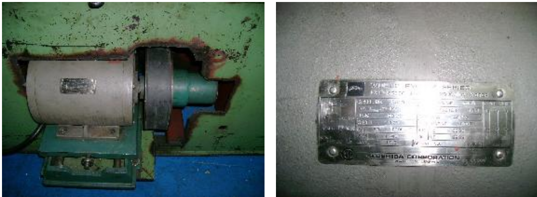
Figura 7. Motor Toshiva de 10 HP, 1740 RPM Fotografías cortesía industrias metálicas Miller.
