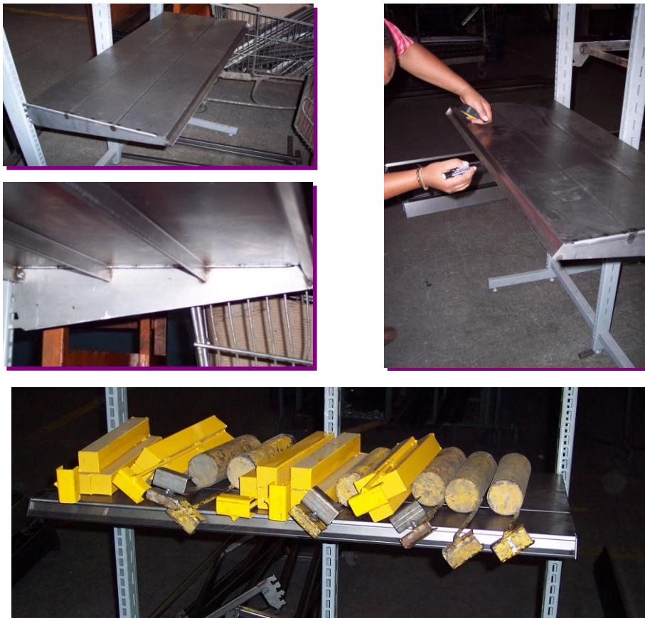
Figura 76. Montaje para la realización de pruebas. Consiste en: columna tipo D, objeto del estudio y los tubo-acoples de unión entre columnas, más un bloque de cemento para cumplir la función de ancla.
