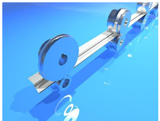
Figura 98. Detalles de rolado de entrapaño repisado tipo CFR DE I303 X 415 mm. A. detalle de los rodillos guía y los formadores principales. B. detalle de rolado de bisel en J. C. Rolado de la canal portaprecio.
