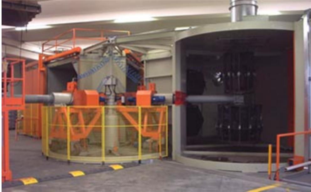
Imagen 28. Máquina tipo shuttle o de rieles
