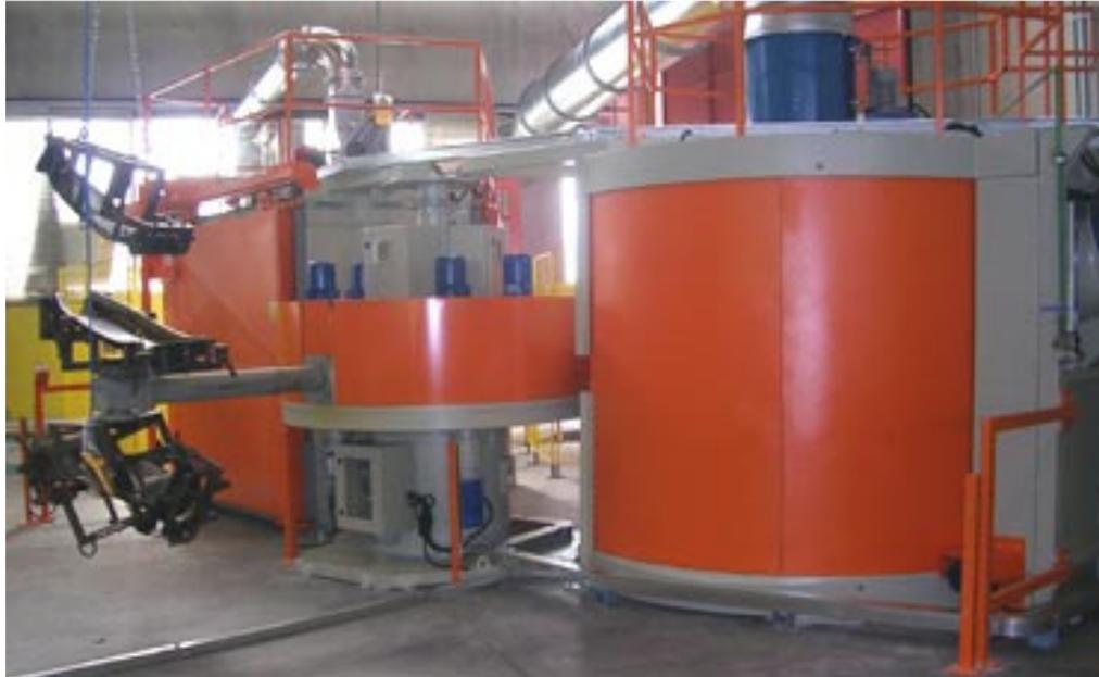
Imagen 30. Máquina tipo caja de horno
