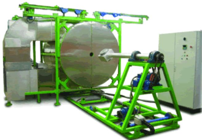
Los artículos que pueden fabricarse por moldeo rotacional aumentan continuamente tanto por las innovaciones implementadas en las instalaciones como por las investigaciones sobre los materiales. Una máquina de moldeo rotacional ofrece la posibilidad de manufacturar la siguiente gama de productos, la mayoría bienes finales de alta rotación:
