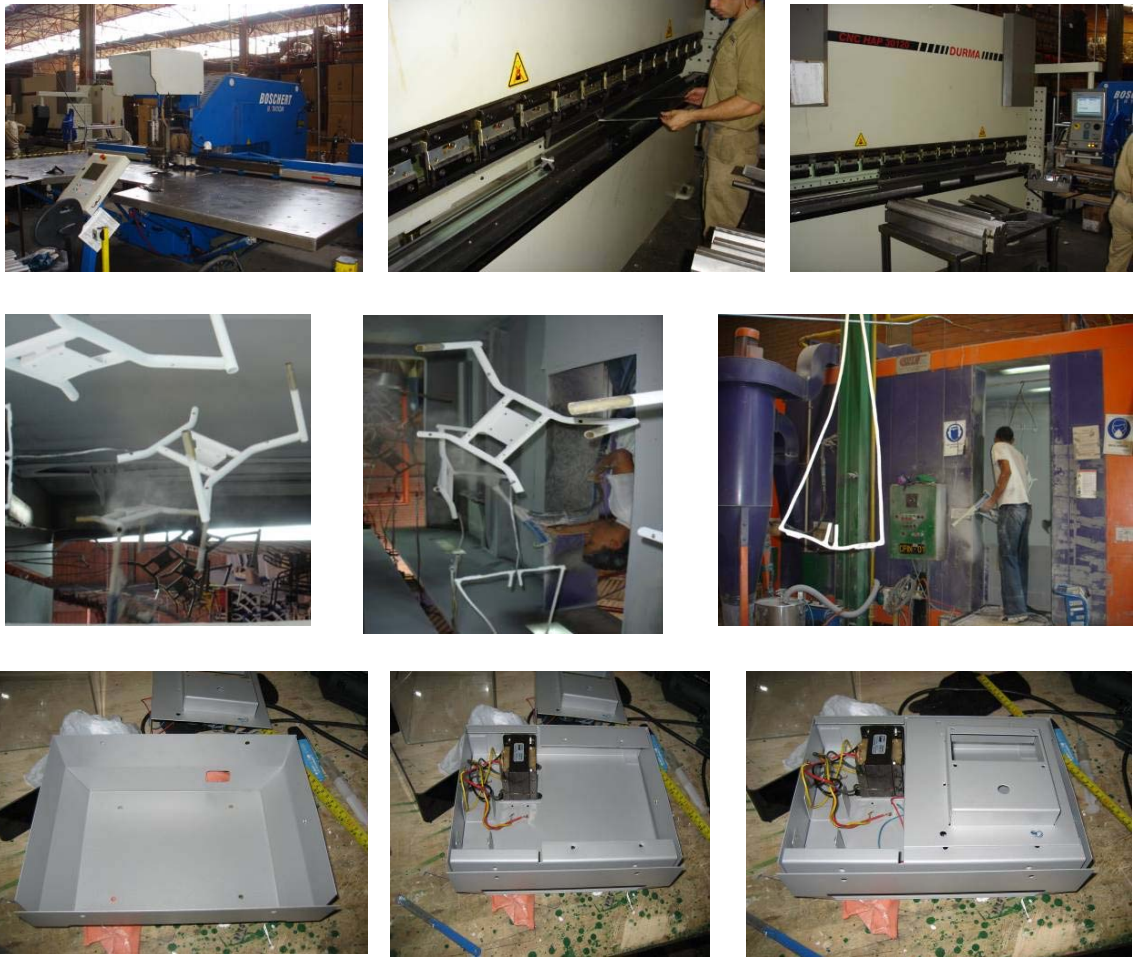
Imagen 6. 7: Proceso transformación de lámina metálica Fuente: Elaboración propia
