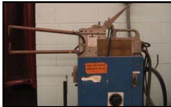
Imagen 6. 5 Soldadura de punto manual
