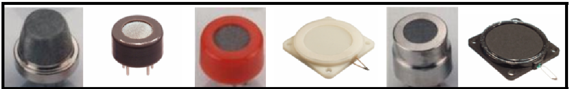
Imagen 4. 3: Sensores electroquímicos del mercado
