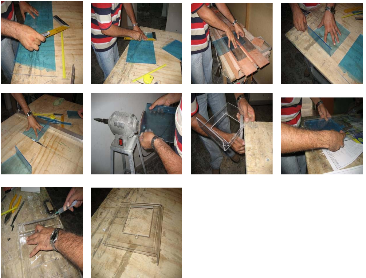
Imagen 6. 6 Proceso de fabricación piezas acrílicas Fuente: Elaboración propia
