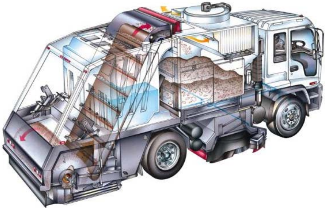
Figura 14. Método de arrastre por cinta transportadora
