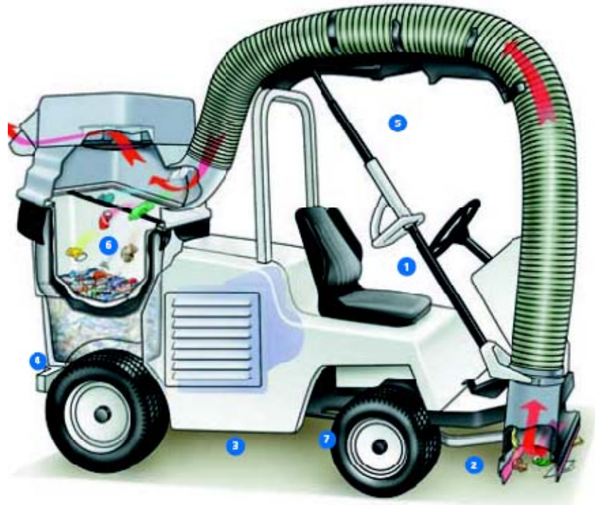
Figura 16. Barredora-aspiradora sin cepillos
