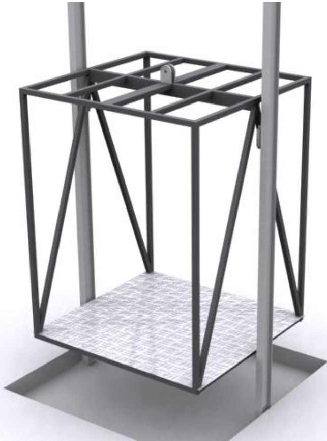
Figura 65. Solución final de la estructura 1, optimizada
