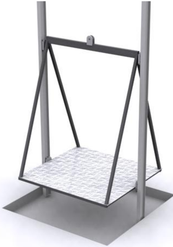
Figura 66. Solución final de la estructura 2, optimizada
