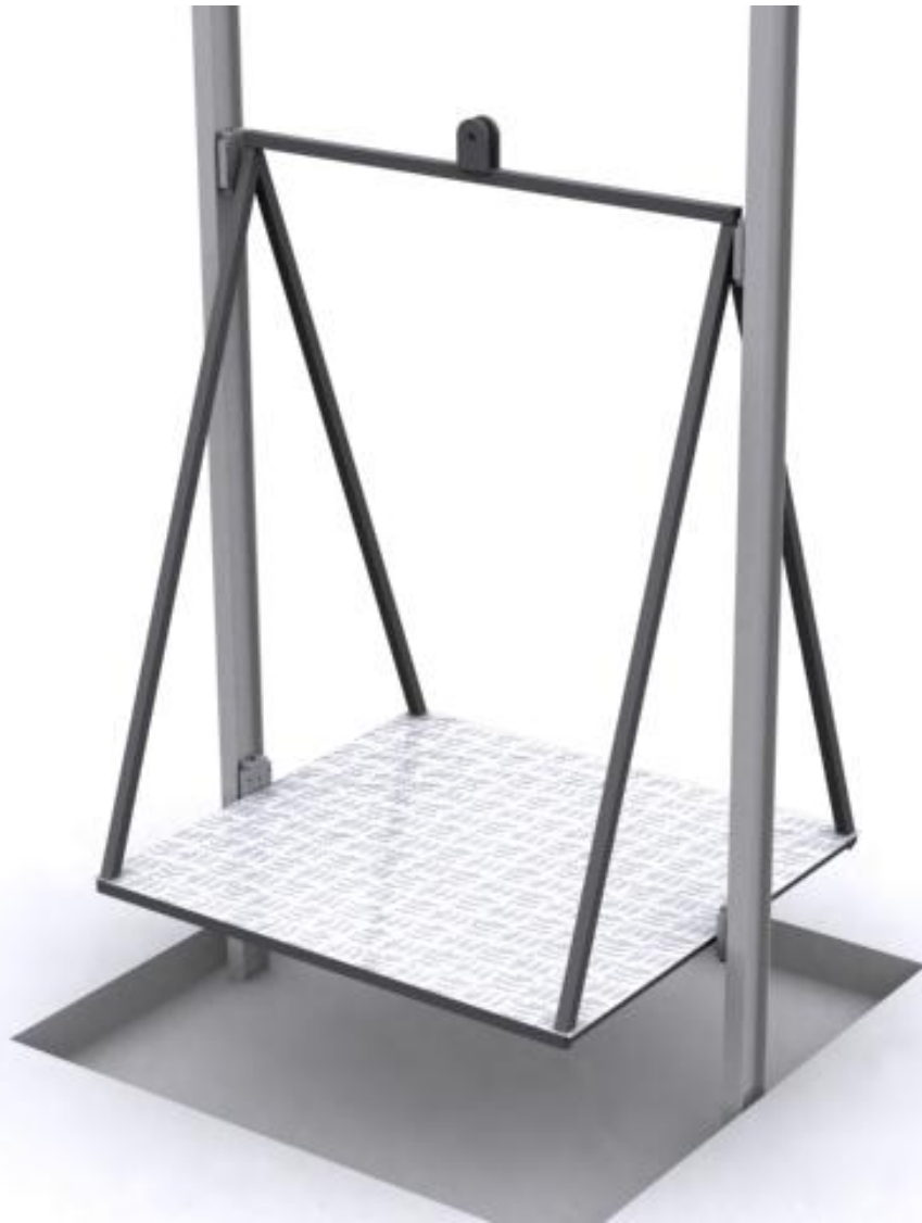
Figura 46. Solución final de la estructura 2, sin cerramientos
