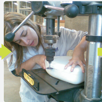
Primeras capas de base blanca y separación (corte) de las dos carcasas
