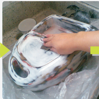
Carcasas con acabados en masilla
