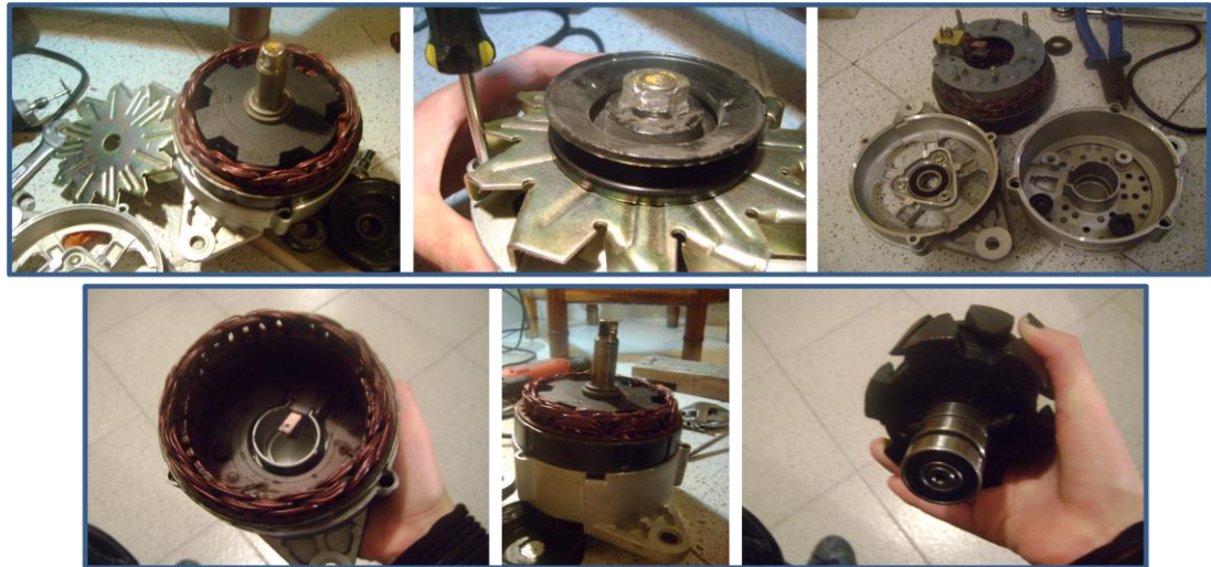
Imagen 5. Exploración y reconocimiento del alternador desarmado para análisis de opciones de modificación
