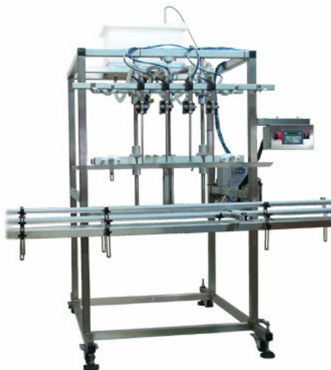
Figura11. Envasadoras con sistema de caída por gravedad automática, 10 boquillas, producción de 10.000 envases por día Fuente: www.liquidfillingmachines.com
