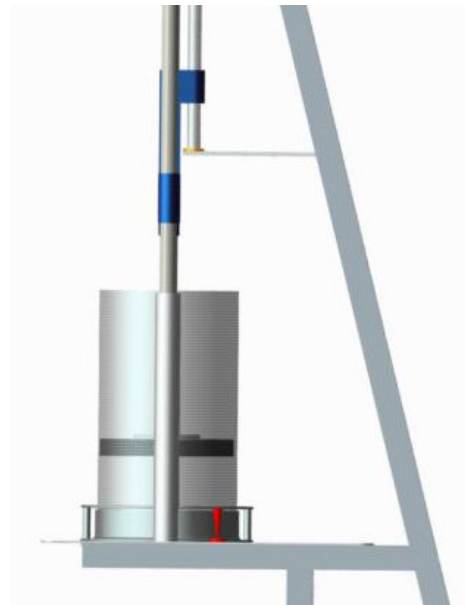
Figura 62. Detalle pistón dentro del cilindro – modelación 3D Fuente: Elaboración propia en pro/E
