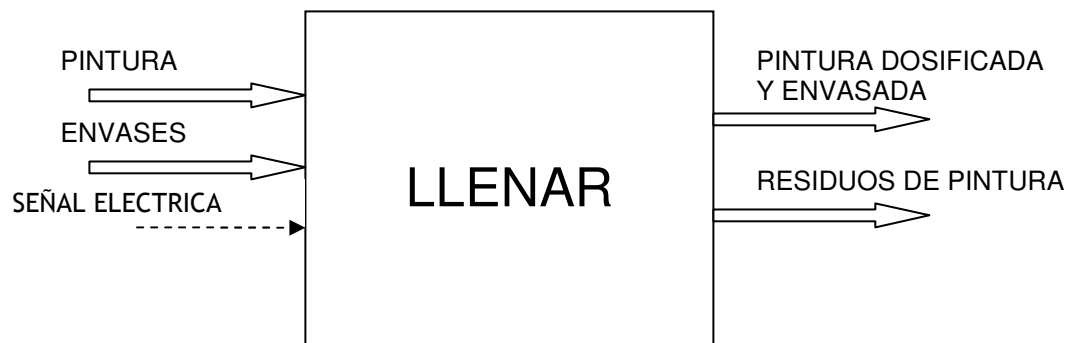
Figura 27. Diagrama de caja negra para la envasadora
