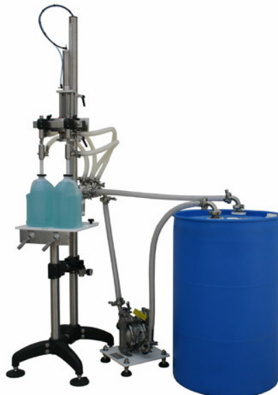
Figura 3. Envasadora overflow semi-manual 2 boquillas, producción de 1000 envases por día
