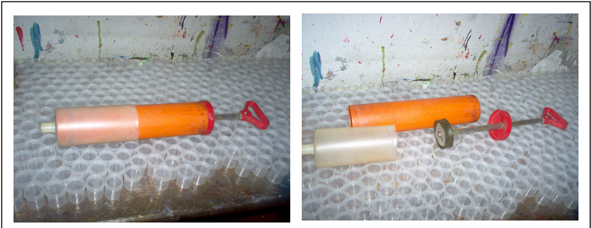
Figura 19. Herramienta de llenado utilizada actualmente, detalle de forma y componentes
