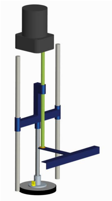
Figura 61. Detalle conjunto embolo-tornillo-motor Fuente: Elaboración propia en pro/E
