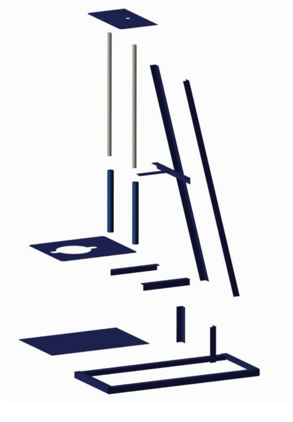
Figura 54. Explosión chasis – modelación 3D Fuente: Elaboración propia en pro/E
