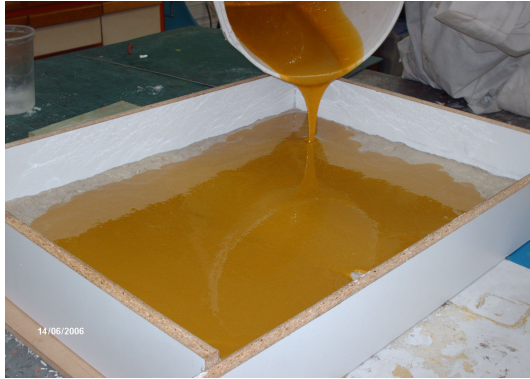
Vaciado de resina para la textura de las rocas
