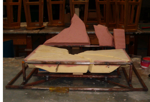
Fabricación de las rocas en Poliuretano y con recubrimiento de masilla.
