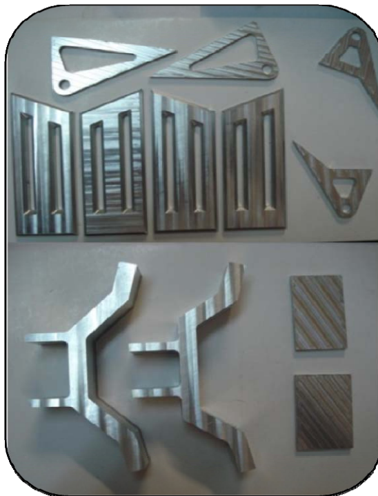
Figura 75. Maquinado final de piezas en control numérico
