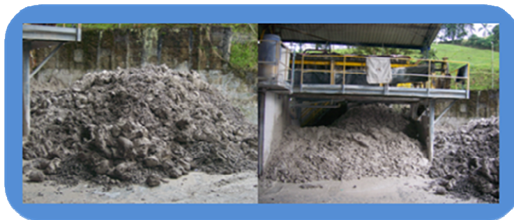
Fig. 6: Almacenamiento de los lodos residuales de Locería Corona S.A. 18
