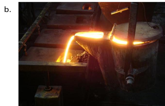
Figura 3-4. a) Post-inoculación b) Vaciado de la colada en los moldes de arena
