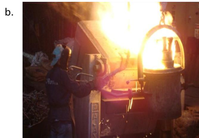
Figura 3-3. a) División de la colada en piquera de 300 kg b) Reacción de nodulización
