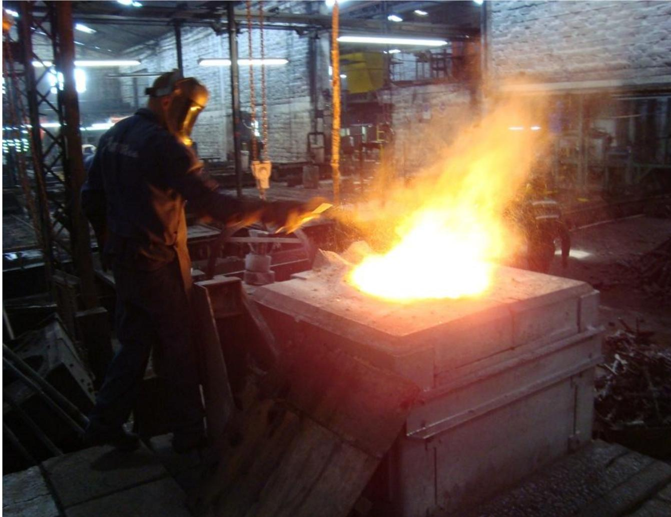
Figura 3-1. Adición del grafito y Ferro-Silicio al hierro base.
