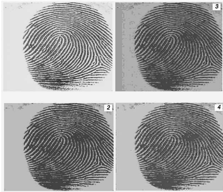
Figura 4.11: Imagen original de la huella digital (arriba a la izquierda) y sus reconstrucciones a partir de versiones comprimidas usando la wavelet Daubechies de orden 1 (abajo a la izquierda), 3 (arriba a la derecha) y 5
