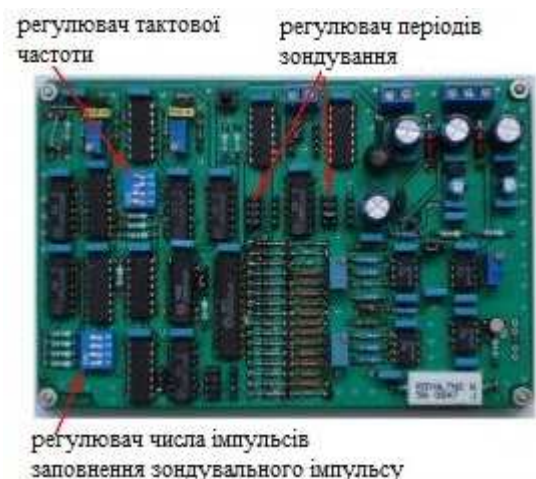
Рис. 8. Зовнішній вигляд монтажної плати формувача
