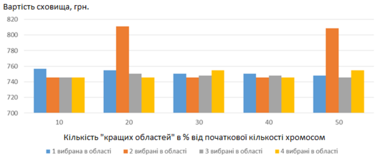
Рис.3.8. Діаграма залежності значення цільової функції від кількості «кращих областей» та вибраних хромосом у цих областях при 40 початкових хромосомах. [Розроблено автором]
