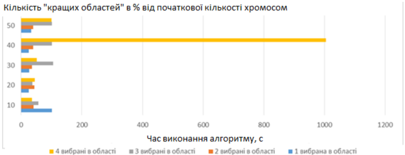
Рис.3.7. Діаграма залежності значення часу виконання алгоритму від кількості «кращих областей» та вибраних хромосом у цих областях при 30 початкових хромосомах. [Розроблено автором]
