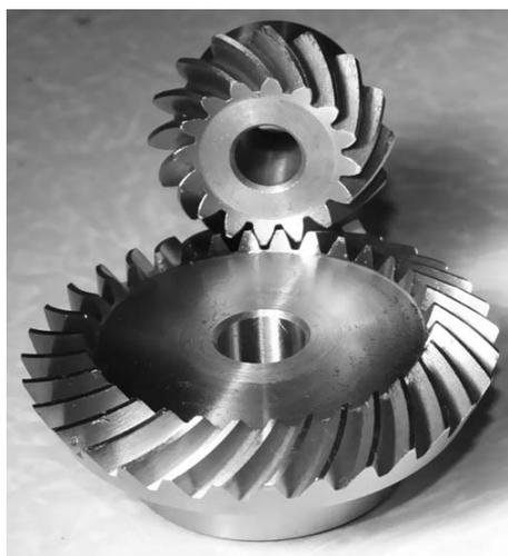
Рис. 1. Коническое колесо с арочным зубом
