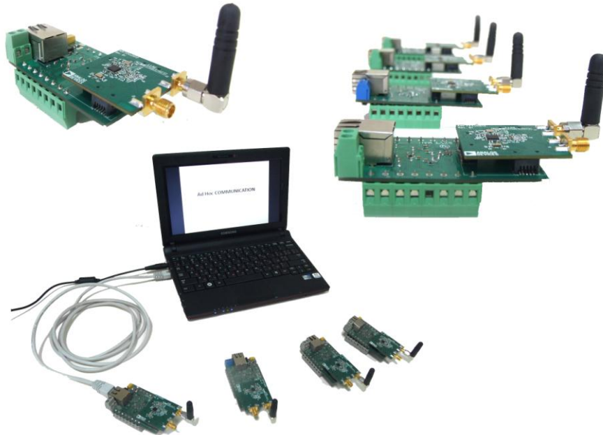
Макети радіотерміналів, які можуть бути об'єднані в радіомережу із самоорганізацією
