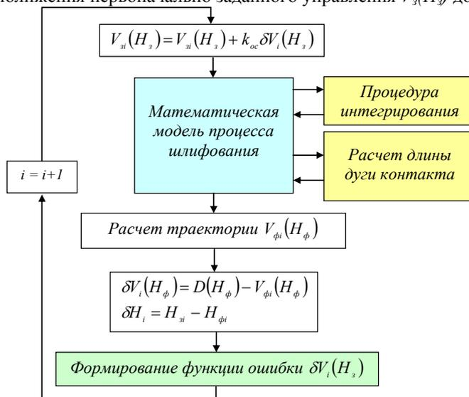
Рис. 6. Итерационный алгоритм решения вариационной задачи оптимального управления
