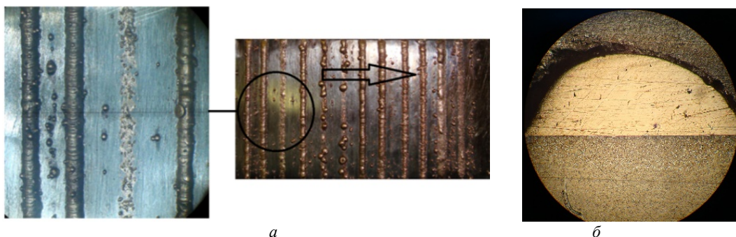
Рис. 6. Загальний вигляд дослідного зразку композиту Бр010. Режими спікання: P = 300 Вт, V = 0,1 - 0,5 м/хв, d_0 = 3 мм. Обробка по стрілці. Шліфи композиту Бр010: а – V = 0,2 м/хв.; d_0 = 3 мм; P = 300 Вт (збільшення \times 32 ); б – V = 0,1 м/хв.; d_0 = 3 мм; P = 500 Вт. Витрати аргону 7 л/хв. (збільшення - \times 100 )
