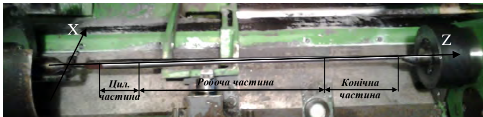
Рис.1. Оправка стану ХПТ в робочій зоні верстата
