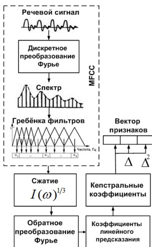
Рис. 1.7. Стадии вычисления MFCC и PLP коэффициентов
