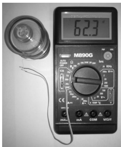
Рис. 3 Вимірювання електричної ємності мікрокабелю касети «Трос» цифровим мультиметром M890G
