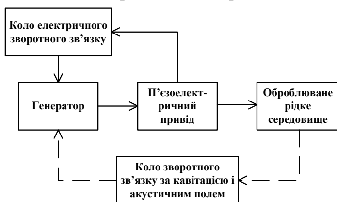
Рис. 1. Структурна схема мехатронної ультразвукової технологічної установки
