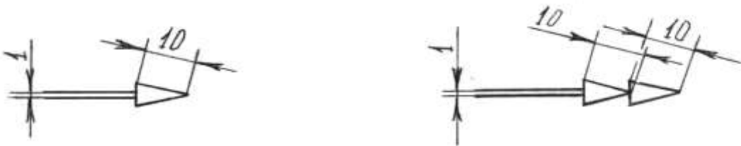
а) УГП інформаційного потоку, спрямованого до ЛО б) УГП інформаційного потоку, спрямованого до ЛО що відображає управлінську або керуючу дію ЛО
