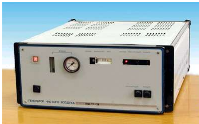
Рисунок 2 –Зовнішній вигляд генератора 950 ГЧ 03
