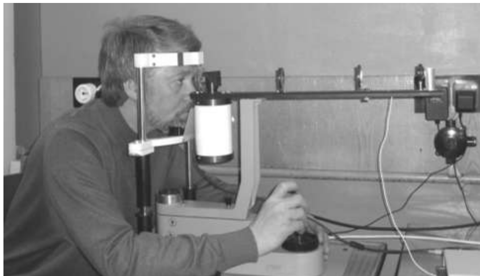
Рисунок 4 – Процедура центрування марок – суміщення візуальної осі ока з оптичною віссю установки
