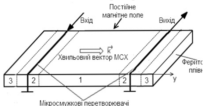
Рис. 1 Схематичне зображення лінії затримки розділеної на автономні блоки: 1 - регулярна хвилеспрямовуюча структура, 2 - мікросмужкові перетворювачі, 3 - відбиваючі краї ЕФП
