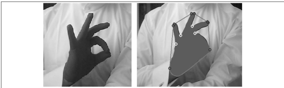
Рис. 2. Пошук та виділення контуру долоні, опуклої оболонки та дефектів
