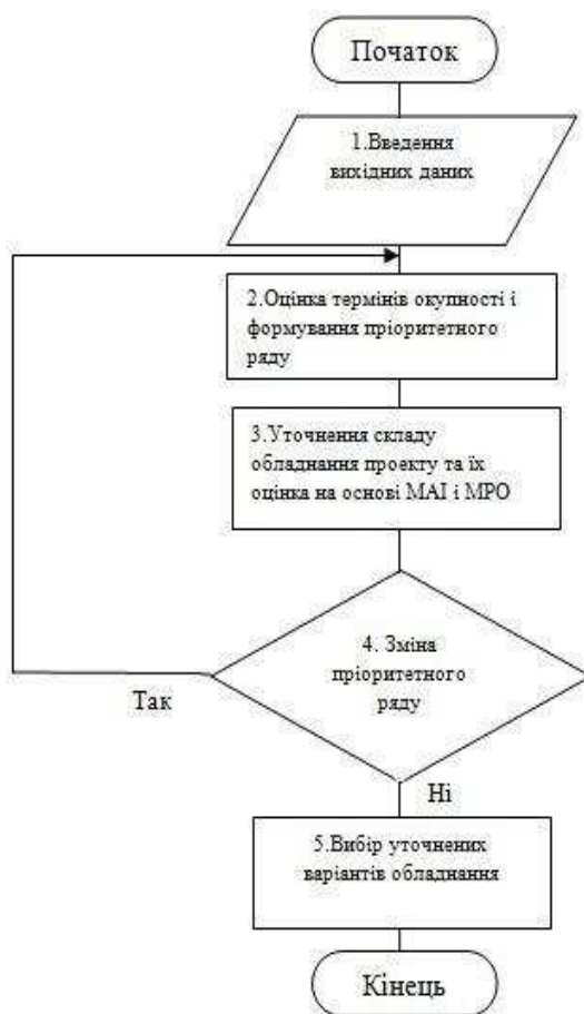
Рис.3. Алгоритм вибору складу обладнання та технологій проектів енергоспоживання на основі СППР
