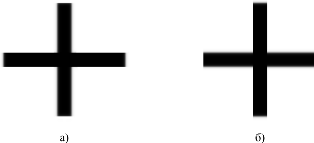
Рис. 7. Синтез зображення тест-об'єкту, що створюється оптичною системою, в якій присутній астигматизм: а - зображення розглядається в сагітальному фокусі; б - в меридіональному
