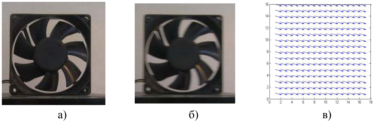
Рис. 5. Результати визначення змазу: а) оригінальне зображення; б) зображення, зміщене на 4.12 пікселів в напрямку 345.9^\circ ; в) векторне поле зміщення
