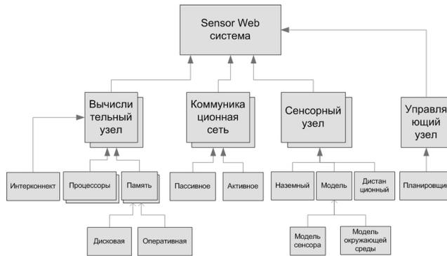
**Рис. 2. Структурная модель системы Sensor Web**
