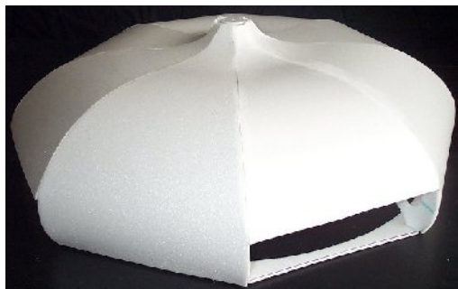
Рис. 8. Вертикальні рулі-клапани, для керування поздовжнім та поперечним рухом
