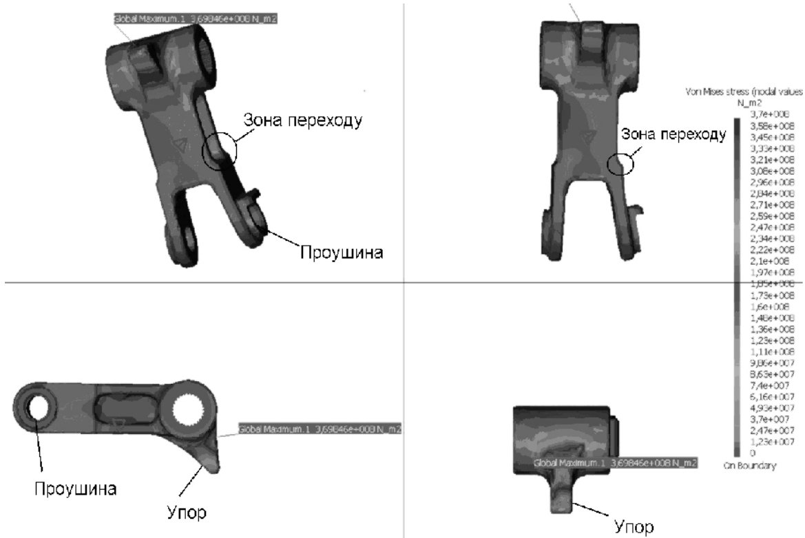
Рис. 7. Розподіл навантажень на деталі засувки
